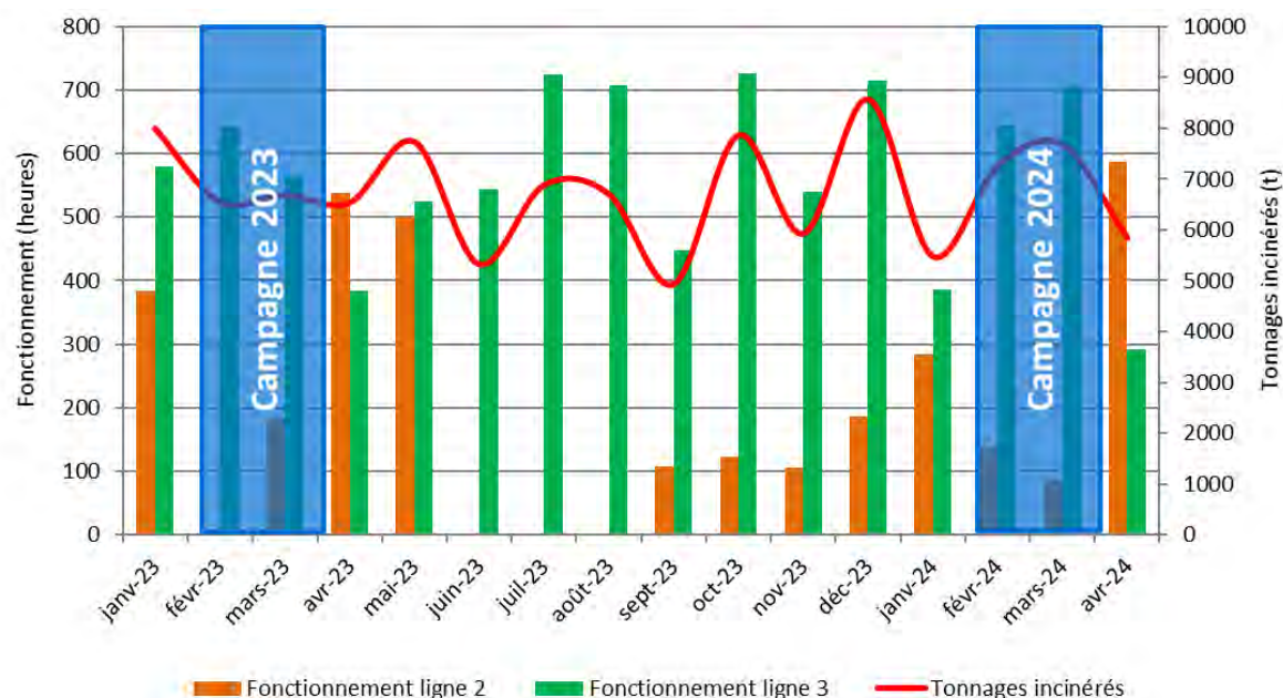
Figure 3. Paramètres de fonctionnement des fours du CVE de Labeuvrière de janvier 2023 à avril 2024
